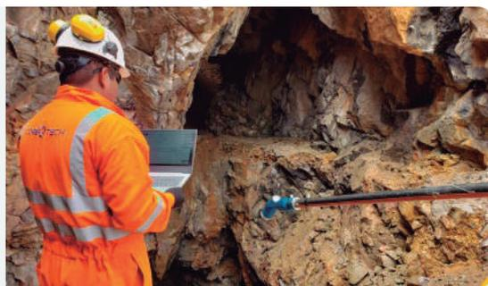
Escaneo de cavidades peligrosas e inaccesibles en operaciones de minería subterránea. Mapeo láser 3d rápido, segura y precisa.
