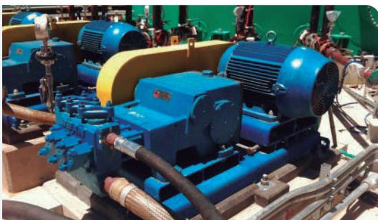
Las bombas de pistón y émbolos de gran eficiencia (85-90%), reducir el consumo de energía y costos de mantenimiento.
