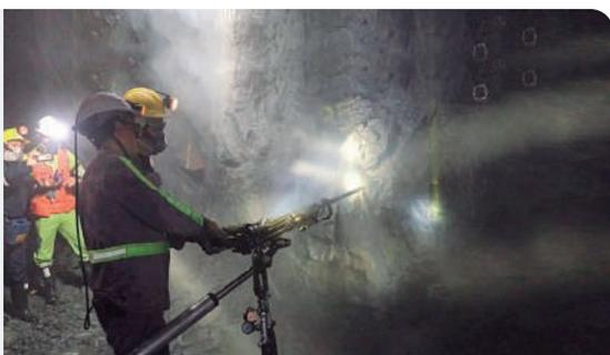
Perforadoras neumáticas de mano para roca, utilizadas en minería y construcción.
